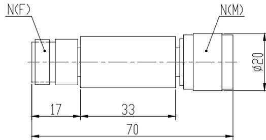
TTF 系列型通过式负载用于隔离终端对讯号源的反射,可用于示波器等仪器设备。
